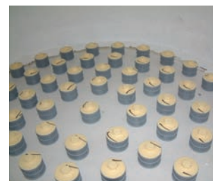
Detail falešného dna se vzduchovými tryskami
