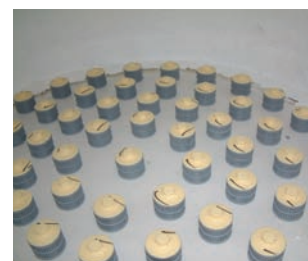
Detail falešného dna se vzduchovými tryskami
