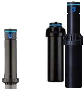
I-20-00-PRB Celková výška: 22 cm Vonkajší priemer: 4,5 cm Vstupný závit: ¾"
